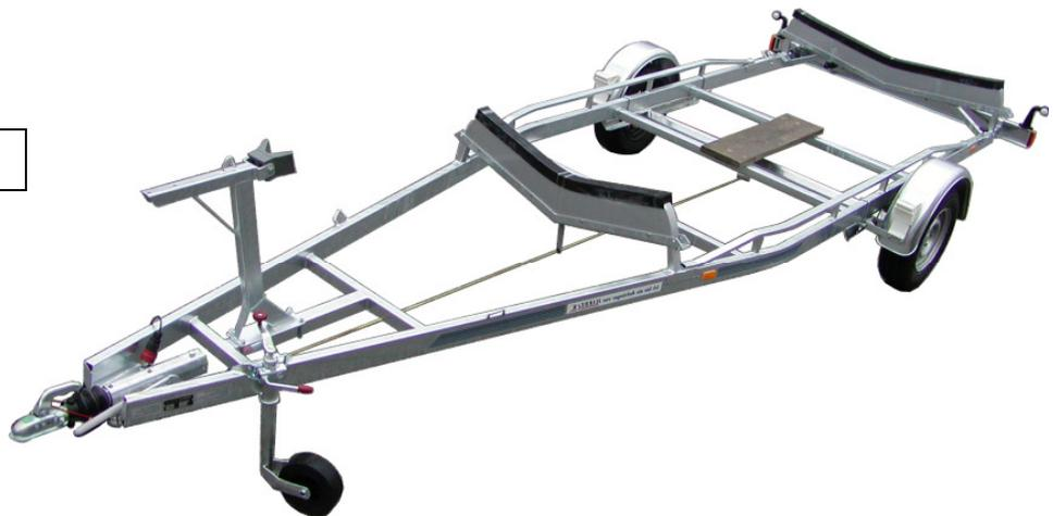
**Serienmäßige Ausstattung:** Stahltrailer verzinkt, **Einfachrahmen, extra lang**, Trailerbreite 2250mm, Auflaufbremse mit Rückfahrautomatik, 50 mm Kugelkupplung, Wasserdichte Radnaben, Querauflagen, Bugstütze, Schwertauflegebrett, Stützrad, Bereifung 14", Beleuchtungsanlage 12 Volt nach EU, Elektrostecker 13-polig, Zulassungsunterlagen („COC“) und Trailer-Datenpass
