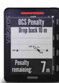
LED-Leiste für einfache optische Erfassung von z.B. Winddrehern, Entfernung/Zeit zur Startlinie oder OCS-Anzeige bei Frühstart.
