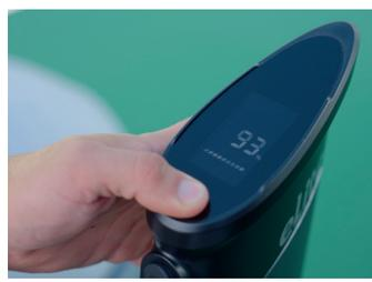
Digitales Display zeigt Batteriestand, Leistungsabgabe, Systemstatus und Warnungen an. Mit der Taste wählt man den Modus und schaltet die Hauptanzeige zwischen Leistungsabgabe und Batteriestand.
