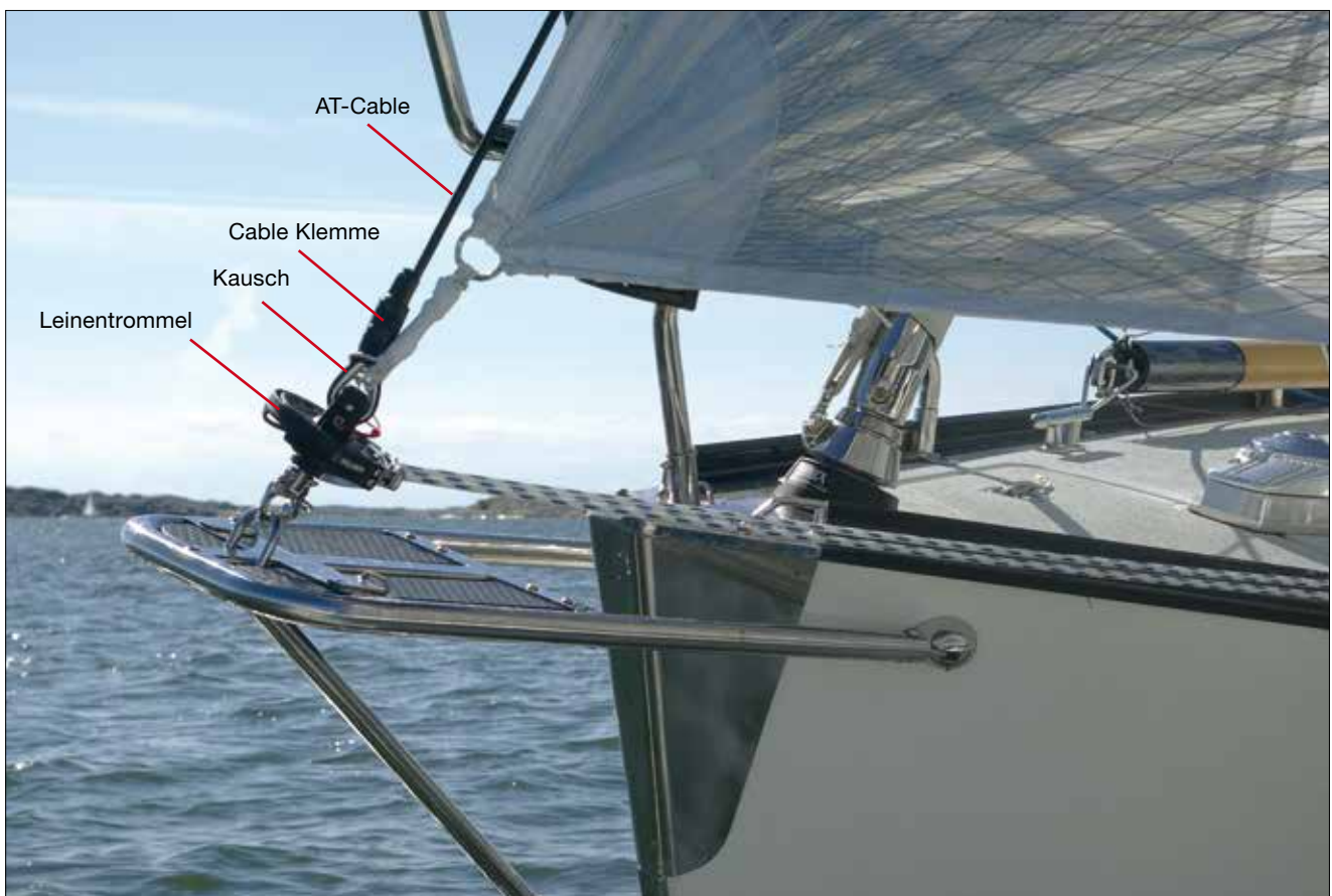
Ein Seldén CX15 für Code 0 auf einer Race 80 Bugplattform von Båtsystem, Schweden ( www.batsystem.se ). Die Vorliekspannung eines Code 0 ist mehr als doppelt so hoch, verglichen mit einem asymmetrischen Spinnaker. Ein sehr stabiler Anschlagpunkt ist daher erforderlich.
