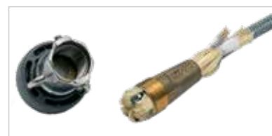
Schieben Sie das Tauwerk-Terminal über das Ende und legen Sie die Seele über die Keile. Schieben Sie dann das Terminal über die Endverbindung.
